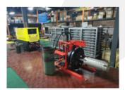
该设备为 PK18,静音式柴油动力液压站 24kw,坡口:双 V 复合坡口。
